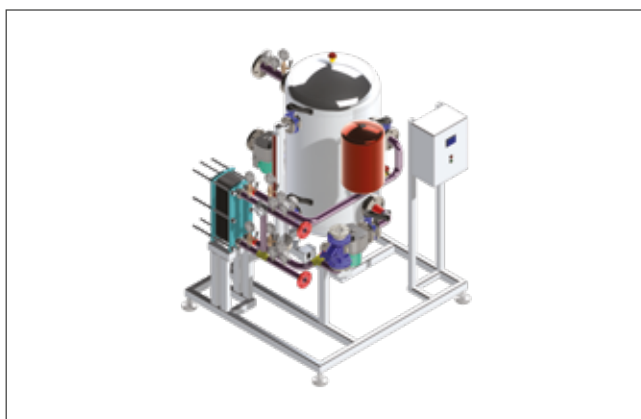
Система подготовки воды с котлом
